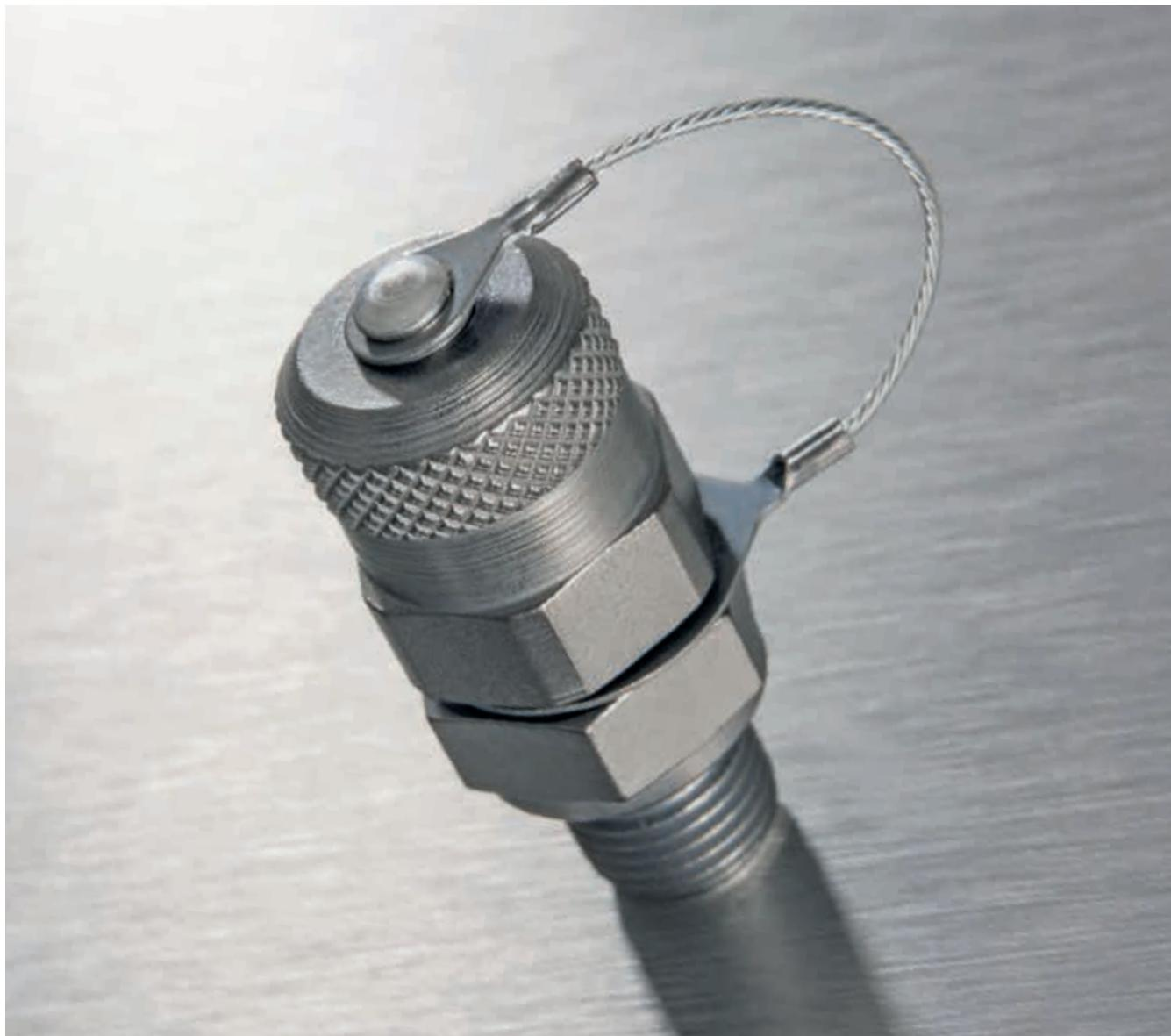
La nuova minipresa MCS® a pistoncino della serie 621 è una soluzione affidabile anche in presenza di fluidi a bassissima viscosità. Il pistoncino, di forma esagonale e autocentrante, grazie ai suoi 6 passaggi di fluido e la tenuta con guarnizione O-ring, riduce le perdite di carico, garantendo una risposta più rapida e una misurazione più precisa.
