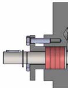
**GLEITRINGDICHTUNG MIT SPERRKAMMER UND AXIALSCHUBAUSGLEICH**
