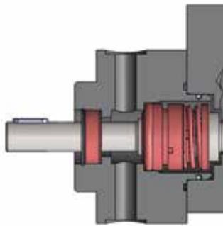
**3-FACH WELLENDICHTRING MIT SPERRKAMMER**
